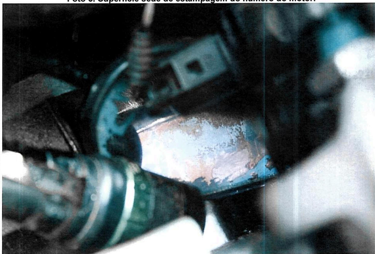
Foto 6. Superfície sede de estampagem do número do motor, após exame químico.
