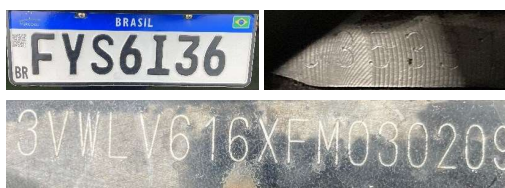
Figura 2 – Imagens da placa traseira do veículo, da numeração do motor (parcialmente visível) e da numeração do chassi
