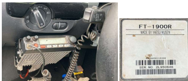
Figura 3 – Imagens do radiocomunicador instalado sob o console frontal e da etiqueta com modelo e número de série
