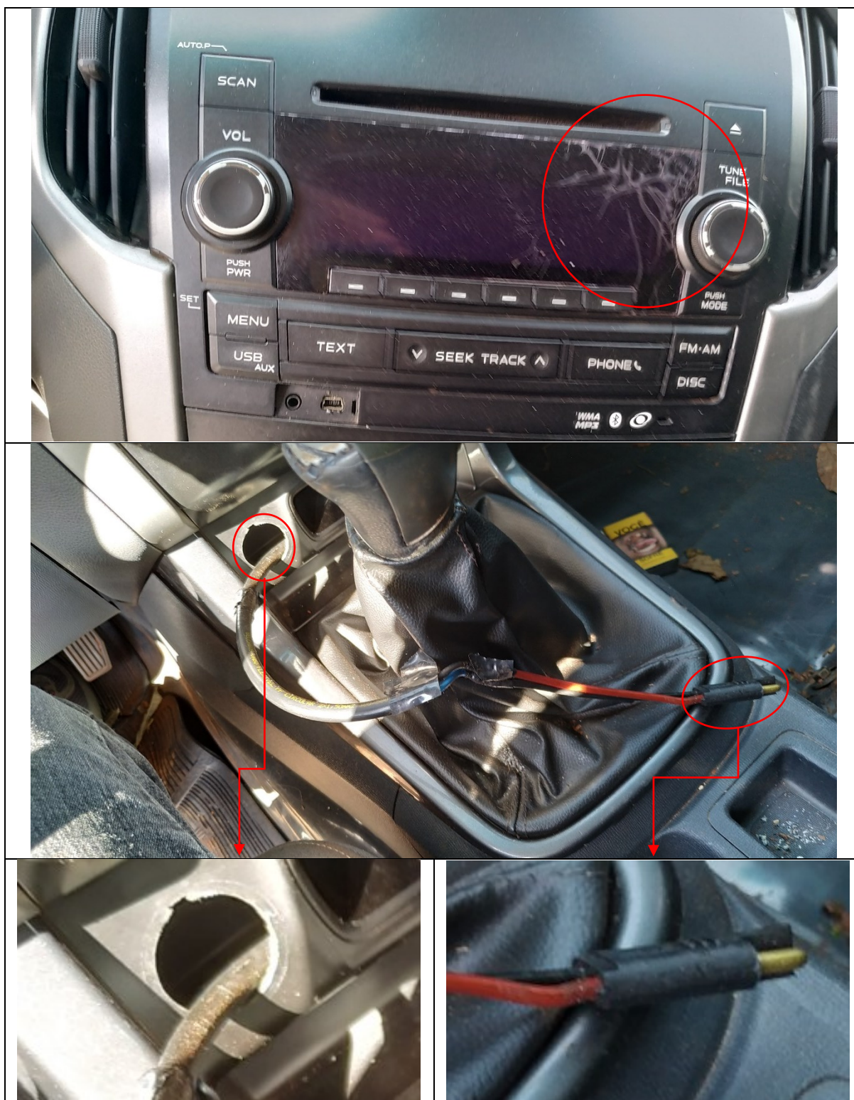
Figura 3: Imagens ilustrativas do equipamento de sonorização de fábrica e cabos elétricos aparentemente adaptados verificados no interior do veículo examinado.
