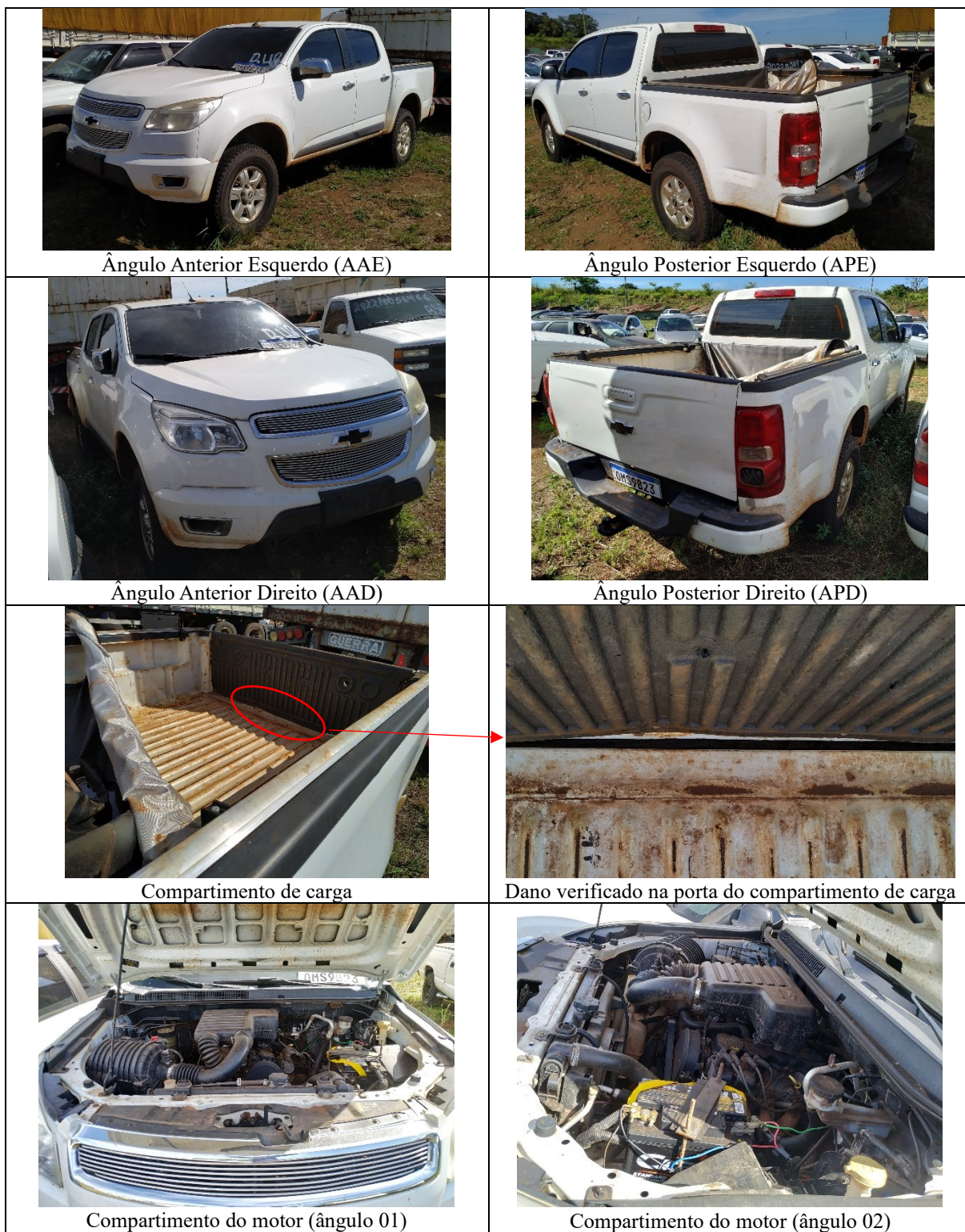
Figura 1: Imagens ilustrativas do exterior, compartimento de carga e compartimento do motor do veículo questionado, com destaque para dano (entortamento) constatado na tampa do compartimento de carga.
