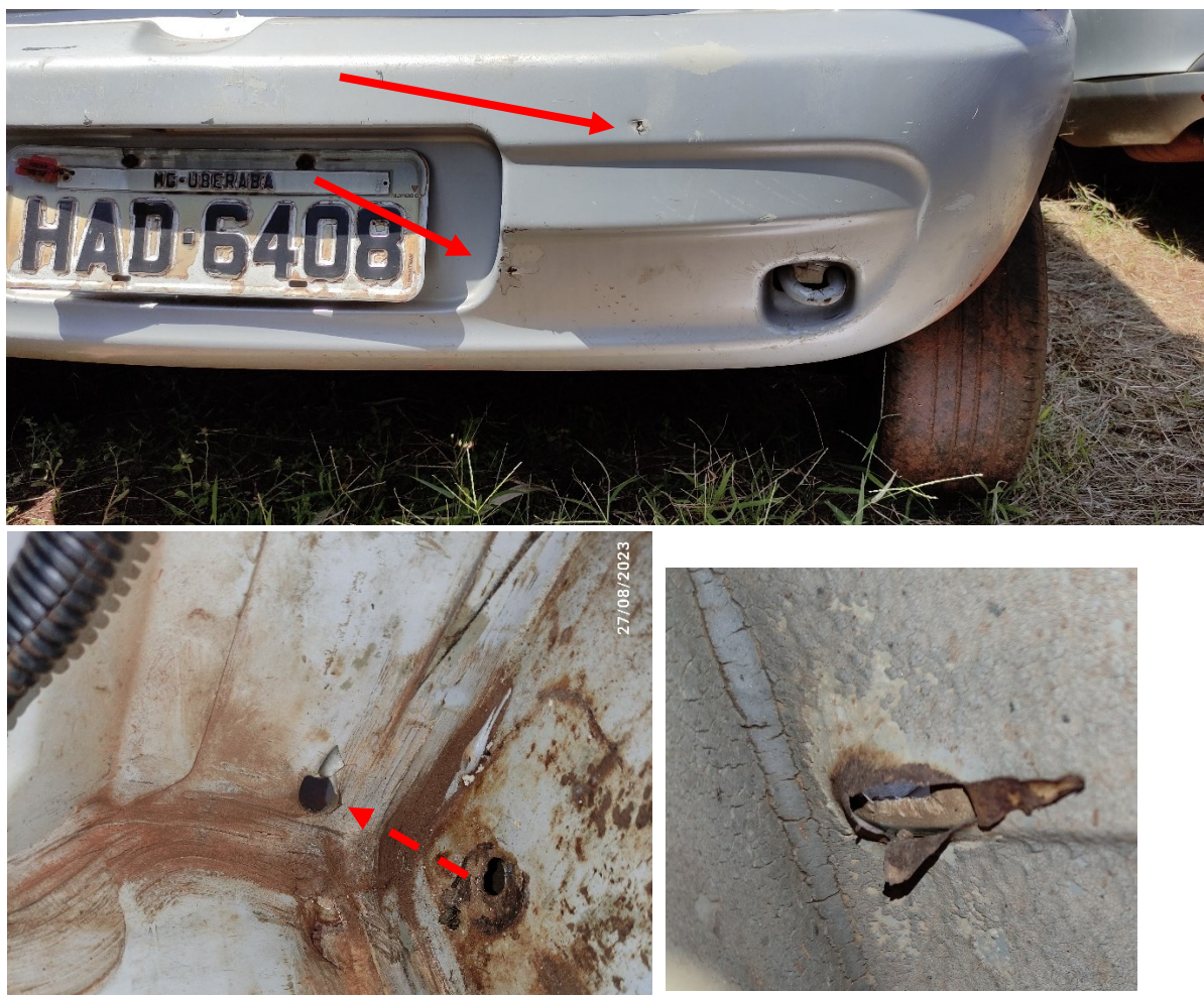
Figura 3: perfurações compatíveis com danos de projéteis de arma de fogo
