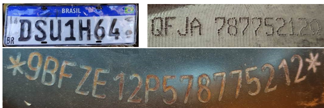
Figura 2 – Dados identificadores do veículo: Placa traseira e numeração de motor (acima) e numeração do chassi (abaixo) – sem sinais visíveis de adulteração
