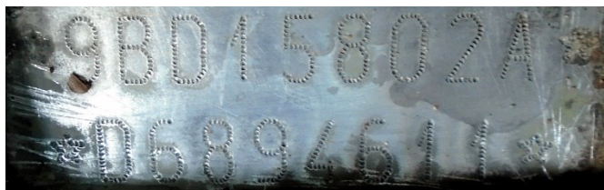
3.c: Numeração VIN marcada em baixo relevo
