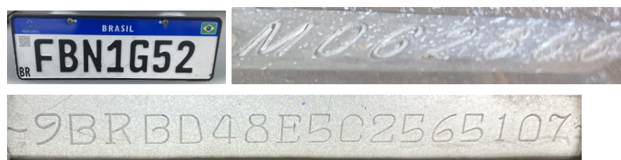
Figura 2 – Imagens da placa traseira, da numeração do motor e da numeração do chassi.
