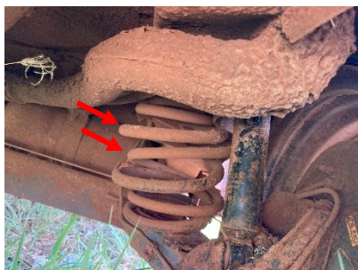
Figura 3 – Imagem da suspensão traseira direita (note as molas helicoidais duplas).
