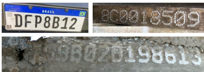
Figura 2 – Imagens da placa dianteira do veículo, da numeração do motor e da numeração do chassi (parcial em razão da oxidação avançada da região de marcação)
