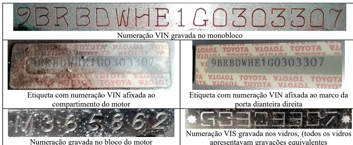
**Figura 2:** Imagens ilustrativas dos principais elementos individualizadores verificados na estrutura do veículo examinado.**IV - RESPOSTAS AOS QUESITOS**
