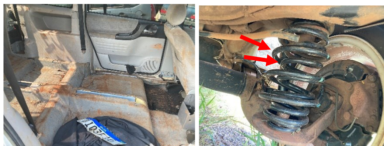
Figura 3 – Imagens do interior do veículo (note a ausência de banco de passageiros) e do sistema de molas duplas na suspensão traseira.
