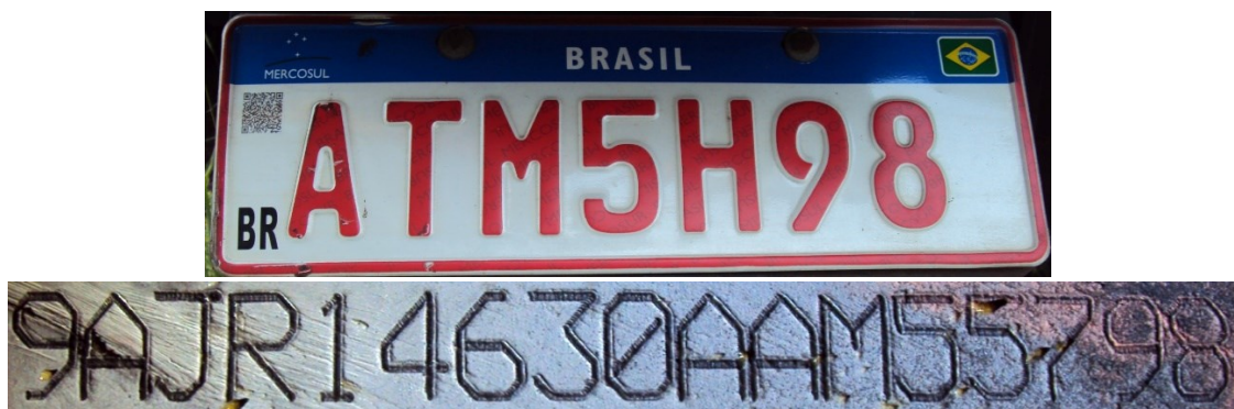
Figura 3 – Dados identificadores Nas imagens: placa e gravação do número de chassi.
