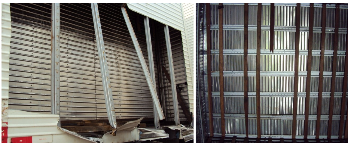
Figura 4 – Local adrede preparado para ocultar objetos À esquerda, porção frontal danificada expondo o compartimento para ocultação. À direita imagem interna da parede do baú, preparado para simular um fundo típico deste tipo de veículo.
