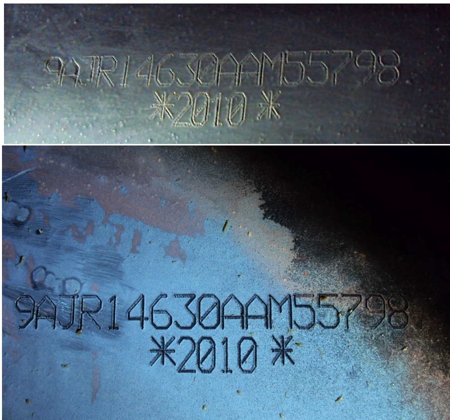
Figura 5 – Numeração adulterada/falsa Acima, numeração do chassi (NIV) antes da remoção da tinta. Abaixo, imagem após a remoção da tinta (não original).
