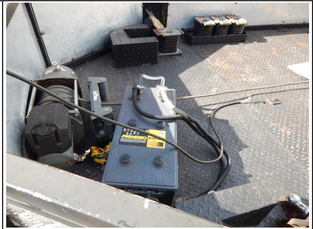
Figura 5 – Guincho elétrico e bateria.
