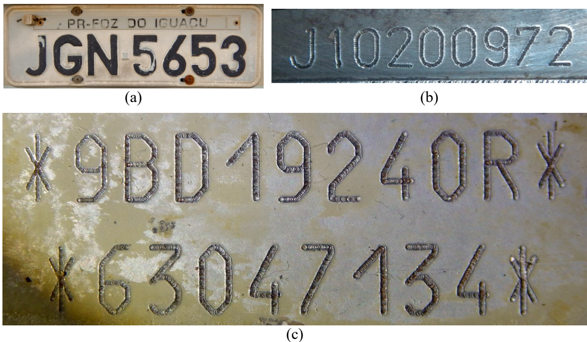
Figura 2 – Dados identificadores do veículo: (a) placa traseira, (b) numeração do motor, e (c) gravação do VIN.
