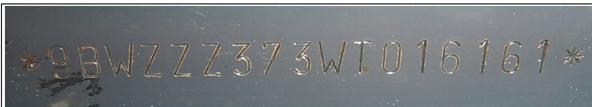
Figura 3 – Local com a gravação do código VIN (chassi).
