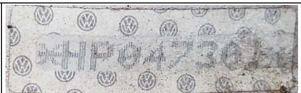
Figuras 12 e 13 – Código VIS gravado em um dos vidros e impresso em etiqueta.
