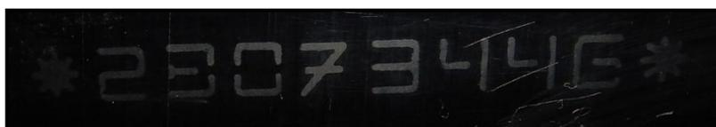
Figura 7 – Marcação do VIS no vidro.
