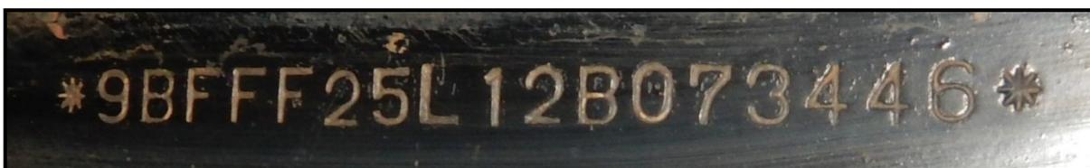
Figura 4 – Número de Identificação Veicular (Vehicle Identification Number, VIN).
