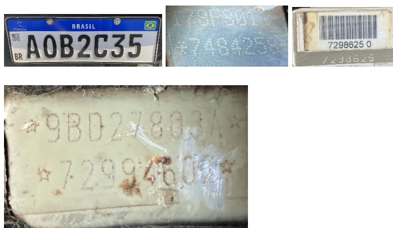
Figura 2 – Imagens da placa não original traseira e das numerações do motor, da carroceria e do chassi
