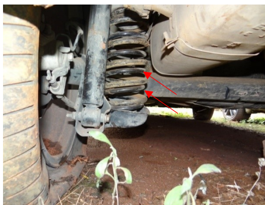
Fotografias 11 e 12 –Molas duplas traseiras do veículo, destacadas nas setas em vermelho.
