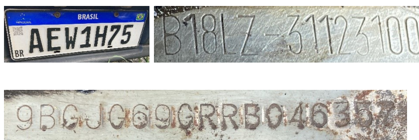
Figura 2 – Imagens da placa traseira, da numeração do motor e da numeração do chassi do veículo
