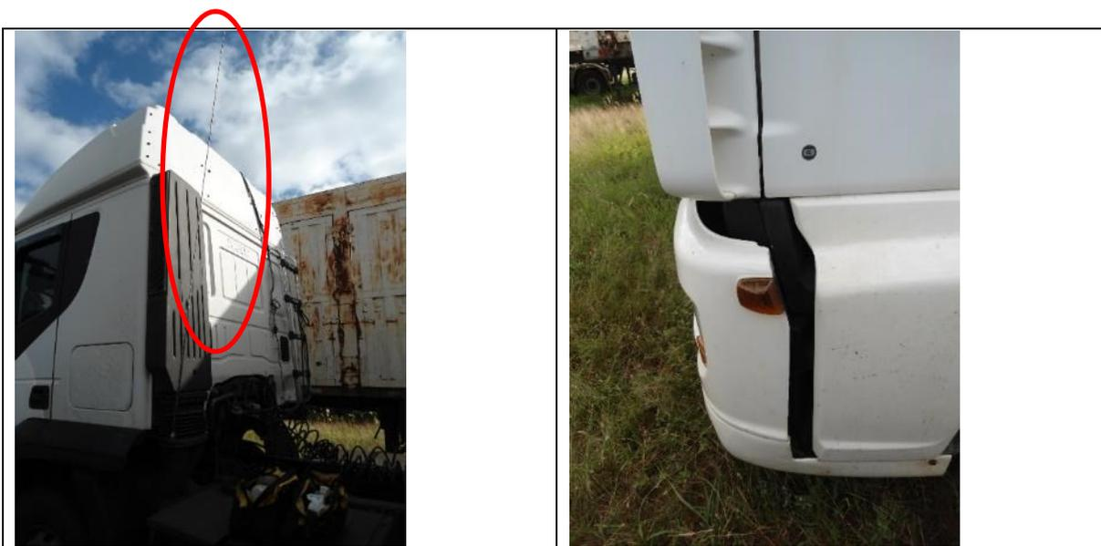
Figura 4: Antena externa e avaria no para-choque.
