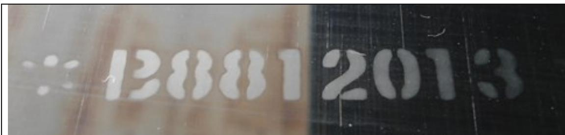
Figura 3: Imagem do VIS em um dos vidros do veículo.
