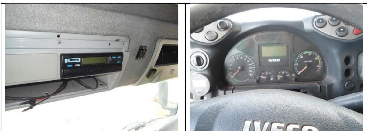
Figura 7: Tacógrafo e odômetro digital no interior do veículo.
