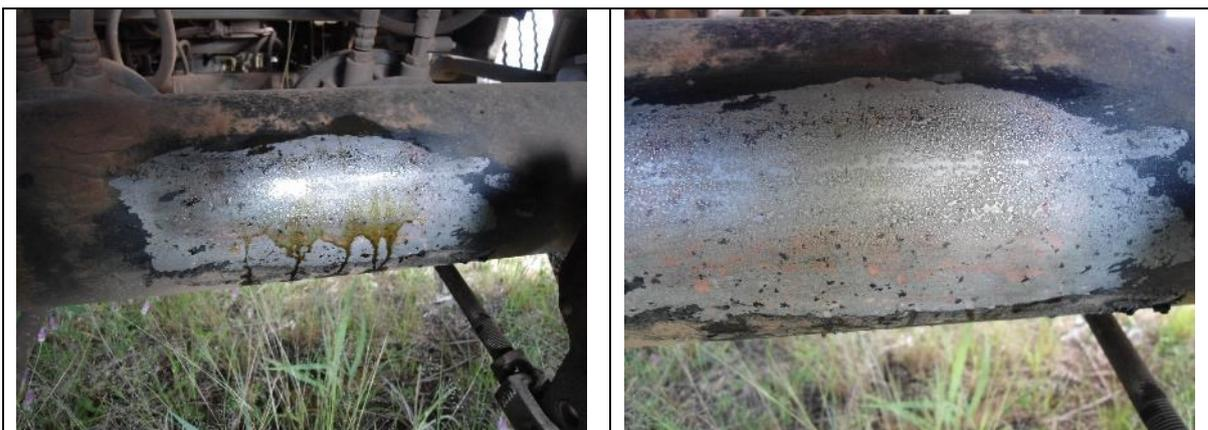
Figura 17: Tentativa de revelação da numeração do eixo traseiro.
