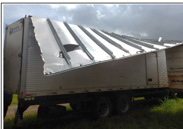
Figura 8 – Parede externa do teto do baú cortada.
