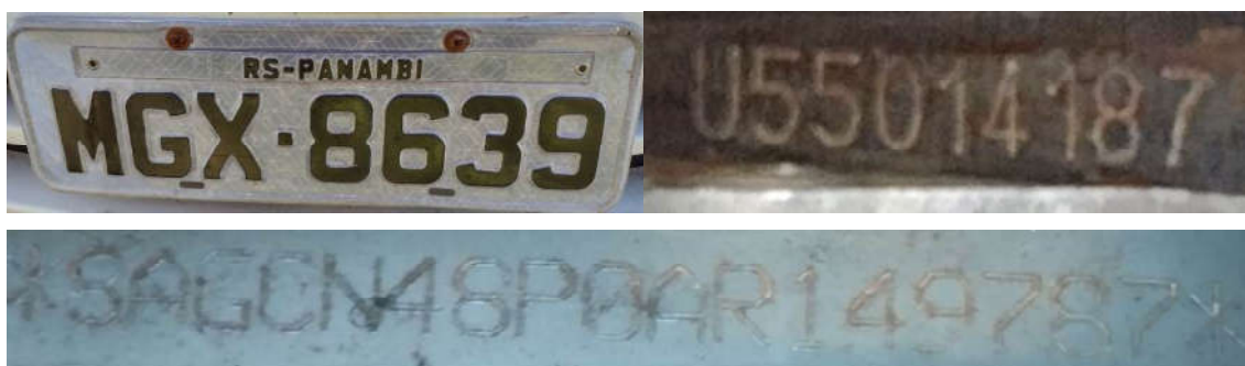
Figura 2 – Dados Identificadores do veículo. Imagens da placa dianteira, nº motor e chassi, sem sinais de adulterações.
