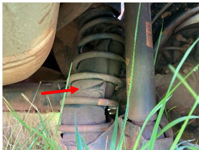
Figura 3 – Imagem da suspensão traseira direita – note a borracha improvisada no interior da mola
