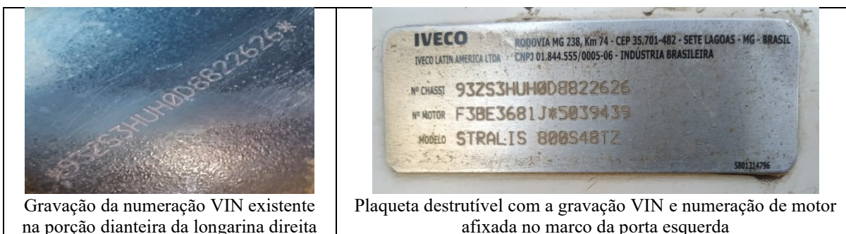
Figura 3: Imagens ilustrativas dos principais elementos identificadores verificados na estrutura do VQ-01.
