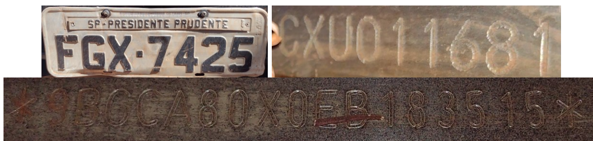
Figura 2 – Dados Identificadores do veículo. Imagens da placa dianteira, nº motor e nº chassi (verdadeiros)
