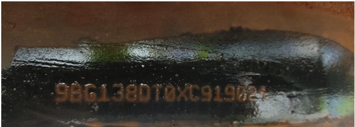
Figura 4 – Gravação do VIN do veículo examinado.
