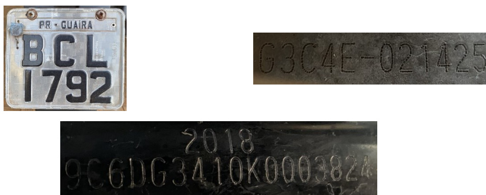
Figura 2 - Dados identificadores do veículo: placa traseira, nº do motor e nº do chassi.
