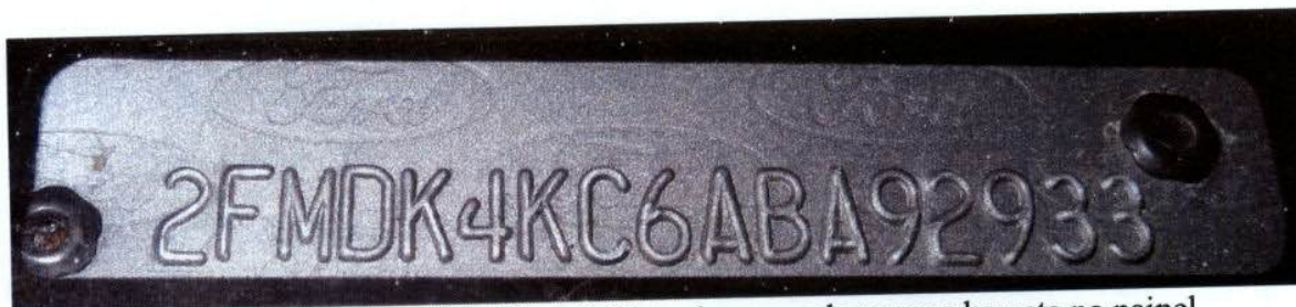
Figura 5 - Número de Identificação Veicular gravado numa plaqueta no painel.
