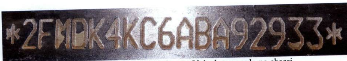
Figura 4 – Número de Identificação Veicular gravado no chassi.
