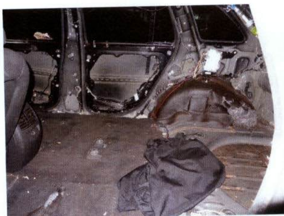
Figura 8 - Ausência dos bancos, com exceção do motorista, e de todo o revestimento interno.
