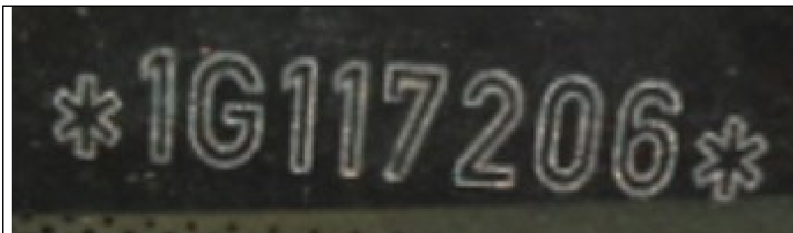
Fotografia 5: Imagem do VIS em um dos vidros.
