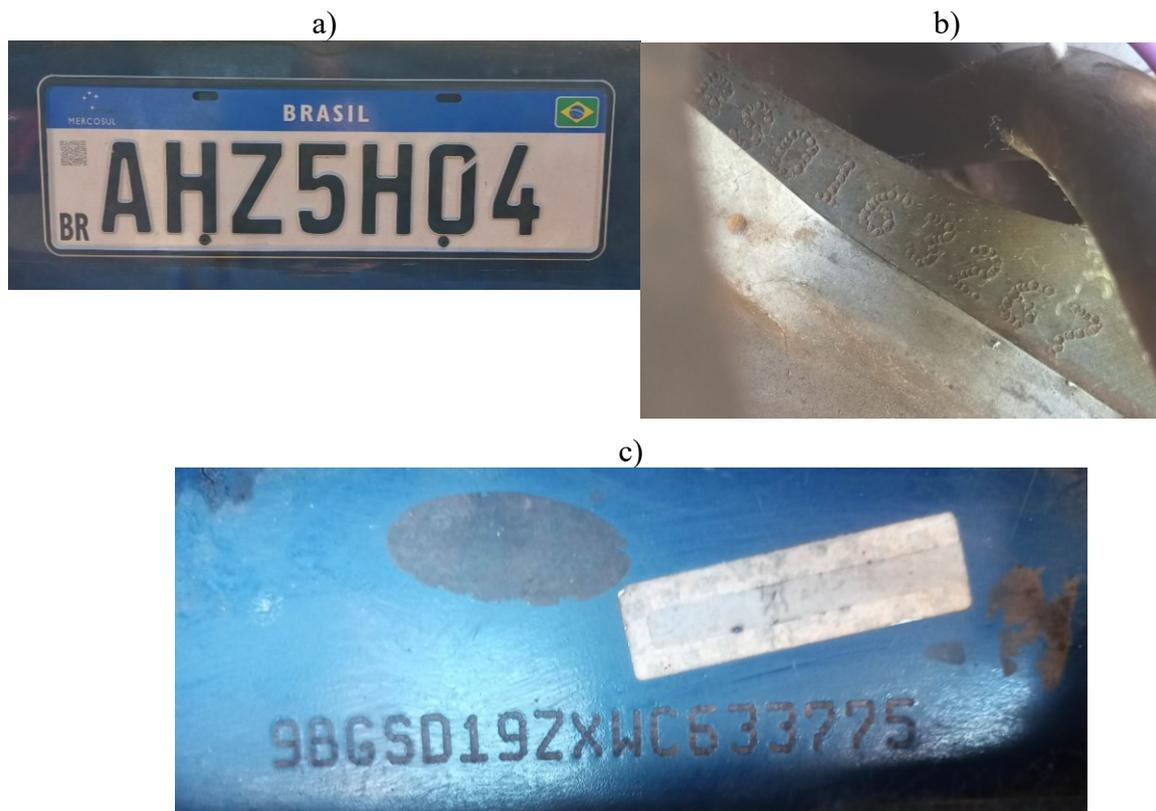
Figura 2 – Imagens dos dados identificadores do veículo. a) placa traseira, b) número do motor e c) número do chassi (VIN), **sem sinais de adultrações.**
