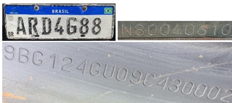
Figura 2 – Imagens da placa traseira, da numeração do motor e da numeração do chassi
