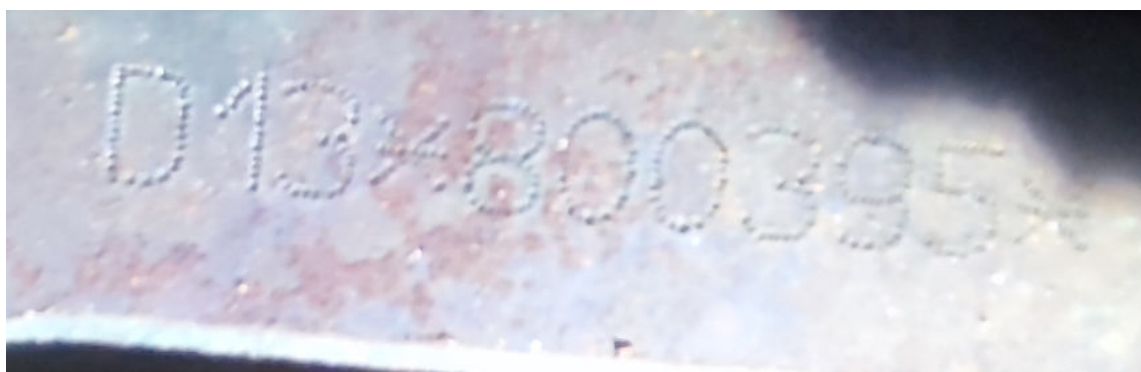
Figura 5 – Gravação da numeração do motor.
