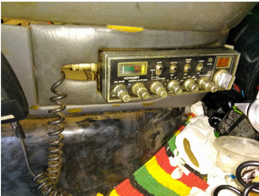
Figura 6 – Rádio instalado no painel de comandos do caminhão trator.
