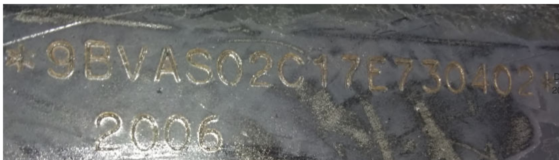
Figura 4 – Gravação do VIN 1 no veículo.
