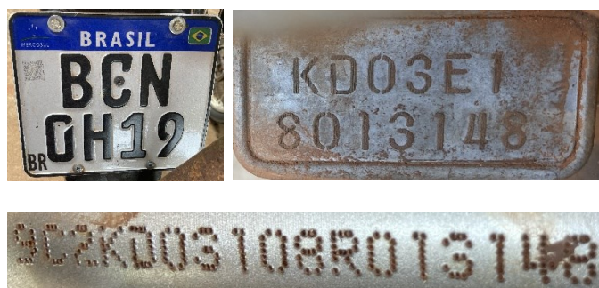
Figura 2 – Imagens da numeração do motor e da numeração do chassi.
