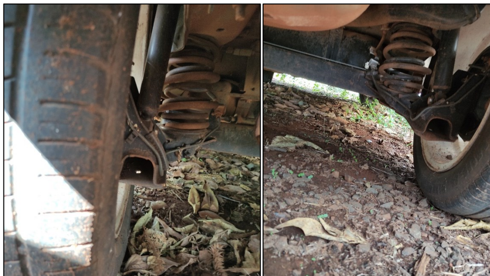
Figura 5 – Molas duplas instaladas na suspensão traseira.
