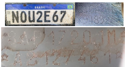
Figura 2 – Imagens da placa dianteira, da numeração do motor (visão parcial) e da numeração do chassi
