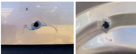
Figura 3 – Imagens de orifícios de entrada e saída na tampa do porta-malas
