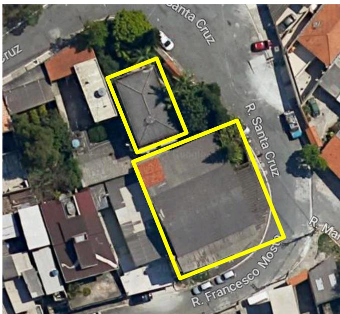
Pelo observado, os prédios foram erguidos com estrutura de concreto armado, fechamento lateral de alvenaria, lajes de concreto armado e cobertura de telhas de fibrocimento e cerâmicas sobre estrutura.
