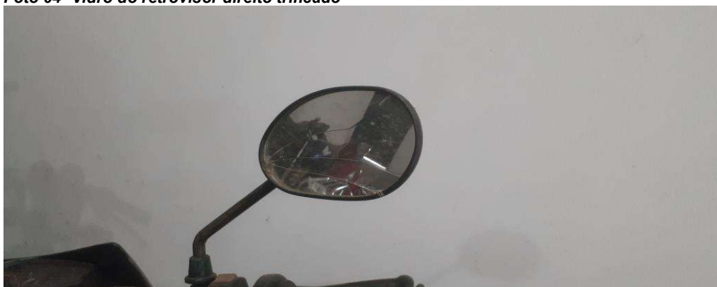
Foto 04- Vidro do retrovisor direito trincado
