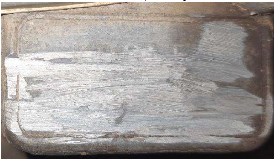
Fotografia ilustrativa 03 – Mostra detalhes da peça suporte da codificação identificadora do motor, totalmente danificada/removida por esmerilhamento.
