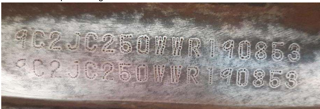
Fotografia ilustrativa 02 – Mostra detalhes da peça suporte e da gravação do NIV.
