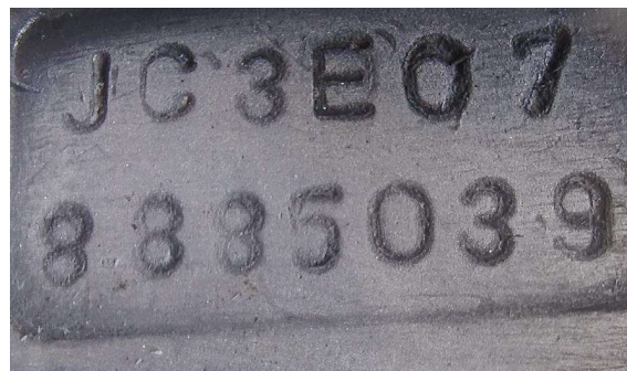
Imagem 2. Sequência Alfanumérica do motor danificada.
