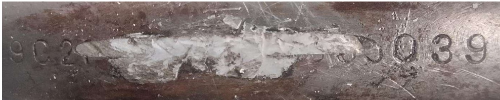
Imagem 1. Mostra detalhes do NIV danificado.
