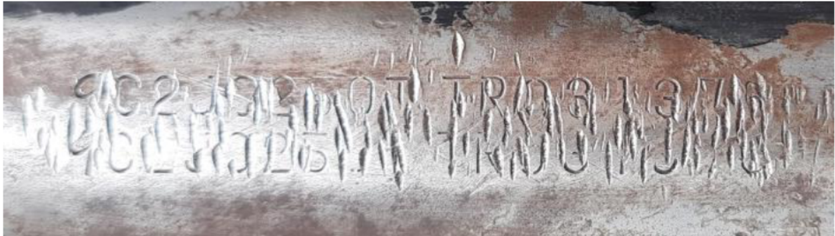
Fotografia ilustrativa 02 – Mostra detalhes da peça suporte da gravação do NIV que foi danificado por amolgaduras.
