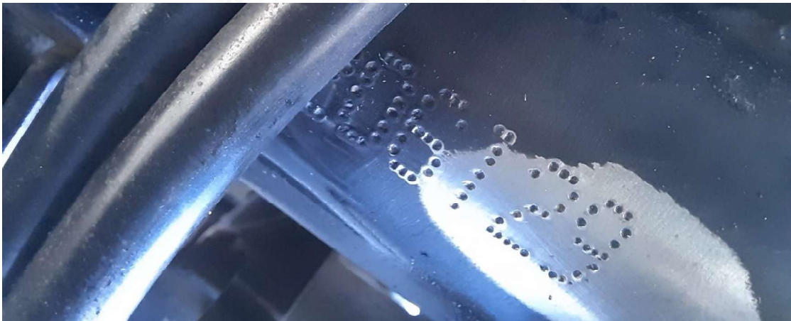
Foto 2: Mostra final da gravação do NIV no chassi. Numeração original 9C2ND1120NR206120.
