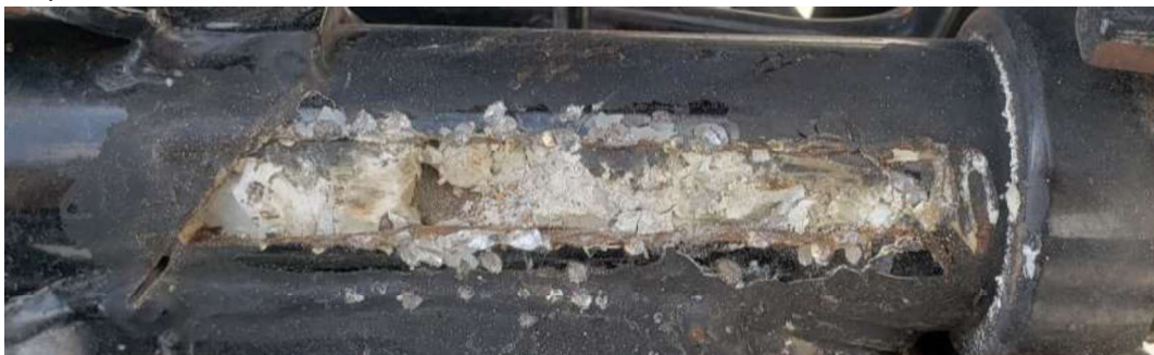
Fotografia ilustrativa 02 – Mostra detalhes da peça suporte do NIV, bem como a cavidade que danificou/removeu toda a sequência alfanumérica identificadora.
