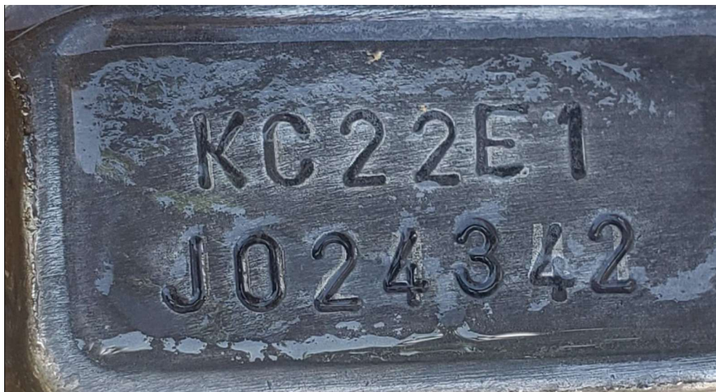
Fotografia ilustrativa 03 – Mostra detalhe da superfície onde normalmente é gravada a codificação identificadora do motor, bem como os caracteres adulterados e os latentes revelados.
