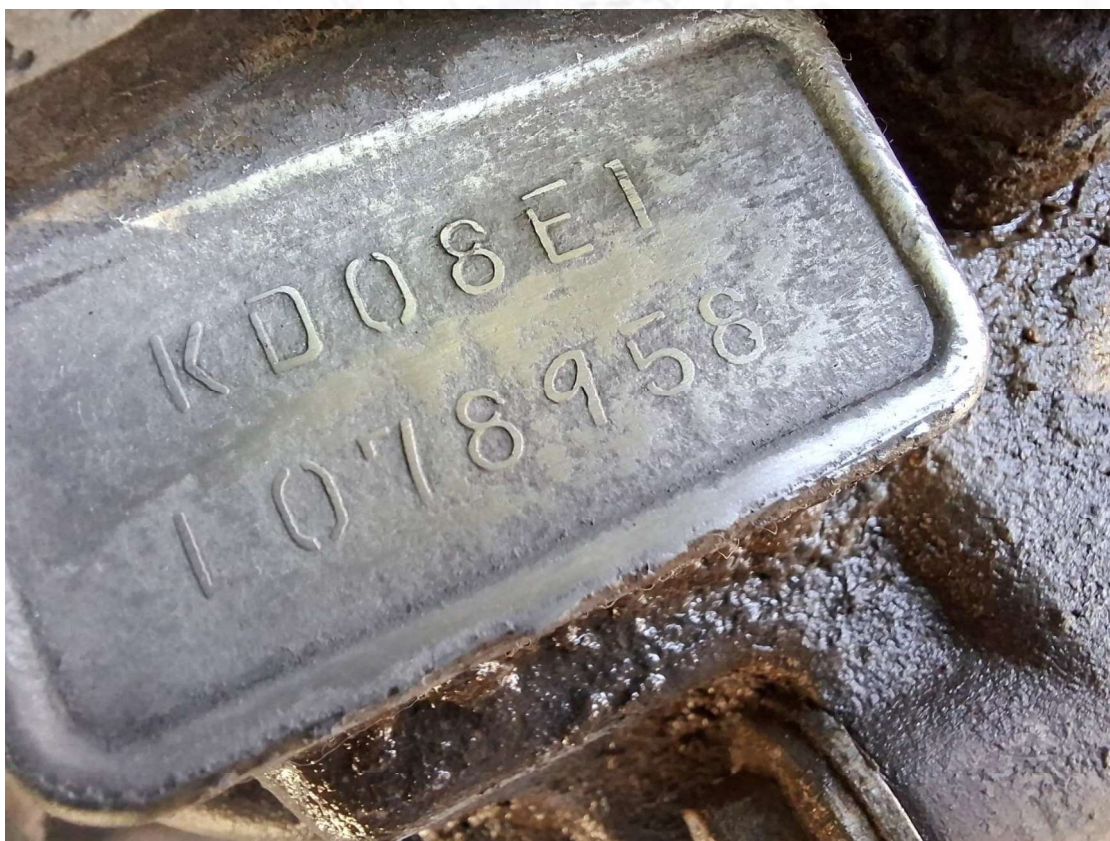
Foto 4: Mostra gravação do número do motor com marcas de adulteração.
