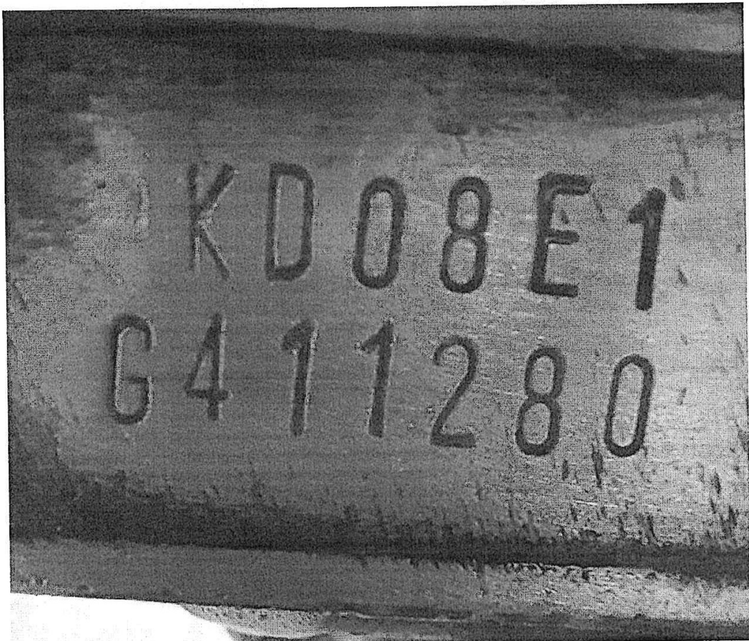
Foto 3: Mostra numeração do motor com caracteres fora de padrão.
