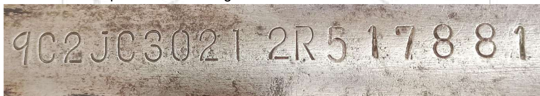
Fotografia ilustrativa de nº 02 – Mostra detalhes da gravação adulterada do NIV observado no veículo.
