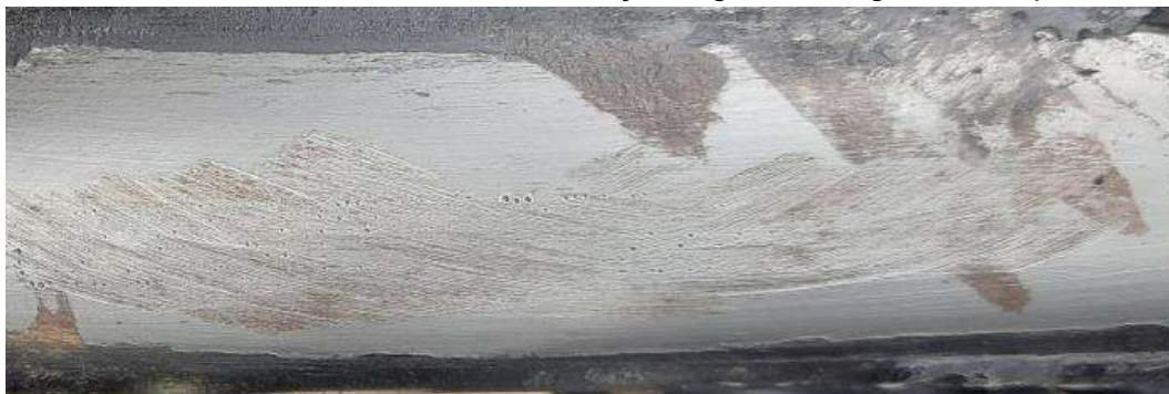
Fotografia ilustrativa – Mostra detalhes da peça suporte da gravação do NIV que foi totalmente danificado/removido.
